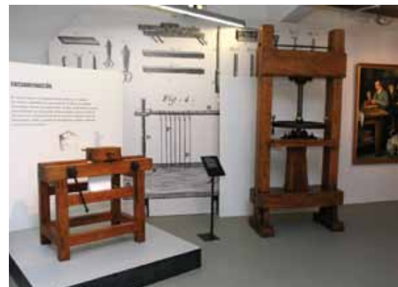
Prensa calcográfica, de la época de Goya. Ideal para imprimir grabados. A la derecha, prensas e ingenios para encuadernar libros.
