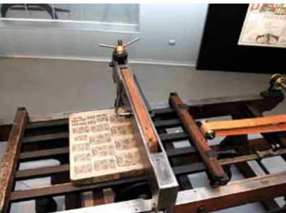
Prensa litográfica, para realizar distintas estampaciones de gran calidad. La piedra actuaba como negativo.
