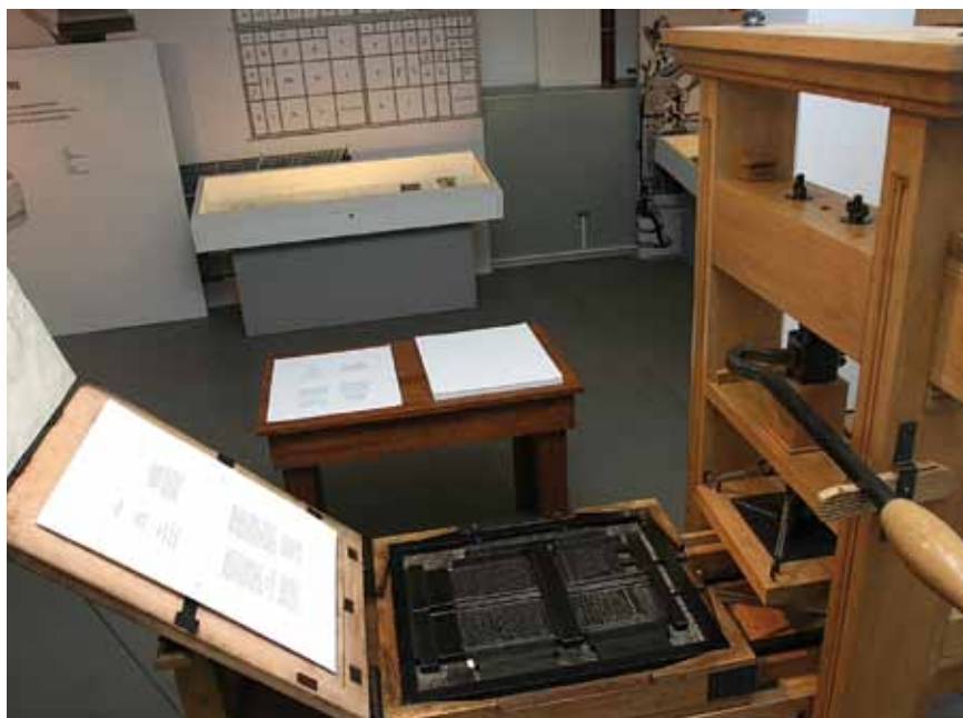
Reproducción de una Prensa de finales del XVI e inicios del XVII, igual a las utilizadas para imprimir "El Quijote".
