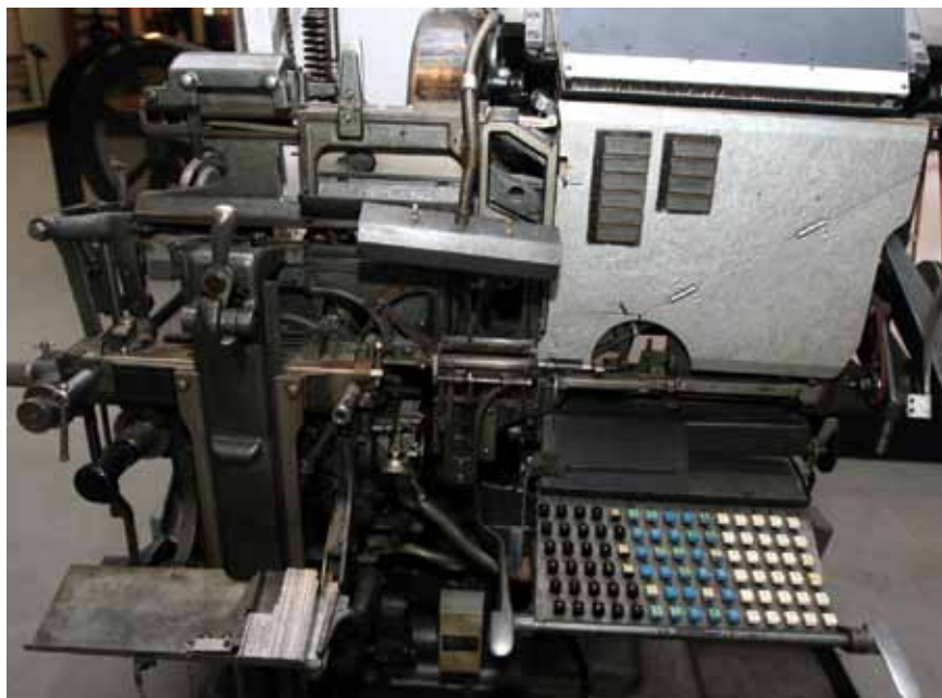
Una linotipia de plomo, con su triple teclado vertical para tipos de letra normal, cursiva y negrita.
