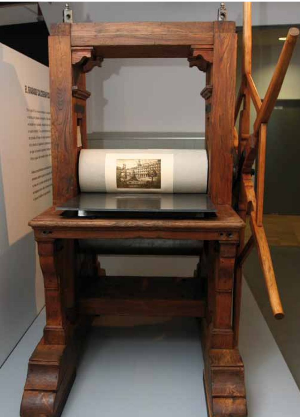
Prensa calcográfica, de la época de Goya. Ideal para imprimir grabados. A la derecha, prensas e ingenios para encuadernar libros.
