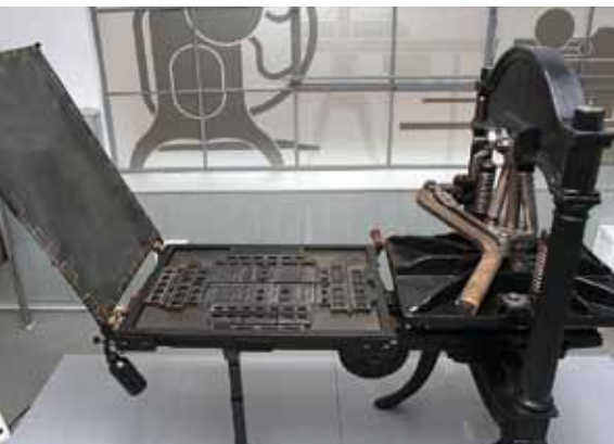
Máquina industrial para obtener pruebas de las ramas, en las técnicas tipográficas de finales del XIX e inicios del XX.
